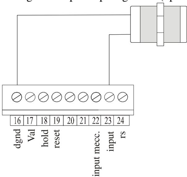
Per collegamento da generatore di frequenza utilizzare i morsetti 23 e 16 (gnd).
