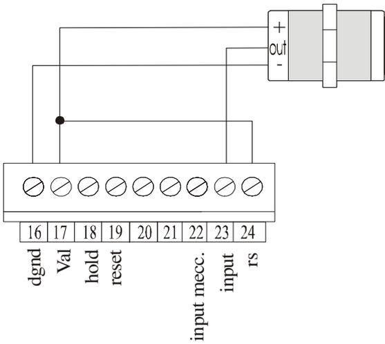
Collegamento trasduttore amplificato PNP
