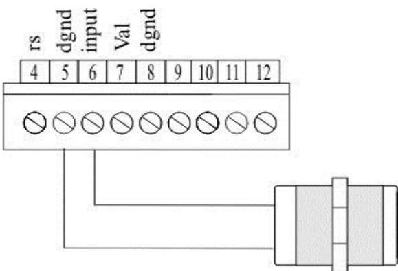
Per collegamento da generatore di frequenza utilizzare i morsetti 6 e 8 (gnd).
